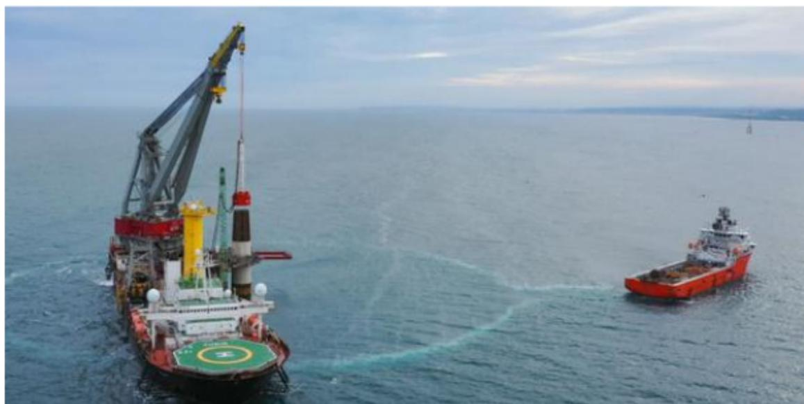
La nave Yudin: è in grado di combinare un'elevata capacità di sollevamento fino a 2.500 tonnellate
